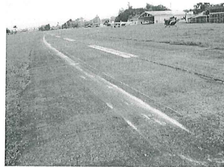
Rastro dejado por el cargo pod y fuselaje inferior de la aeronave hasta el punto en que se detuvo.
