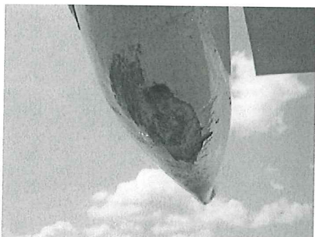
Agujero en la parte inferior del estabilizador vertical derecho
